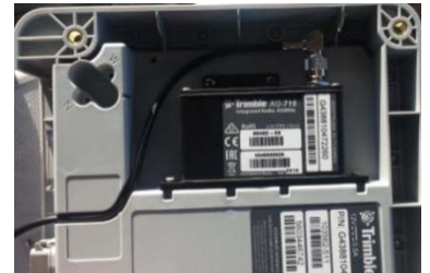
Módulo de radio Trimble conectada dentro del receptor
